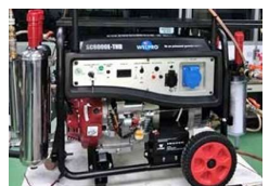
Mit Plasmoid umgebauter Generator
